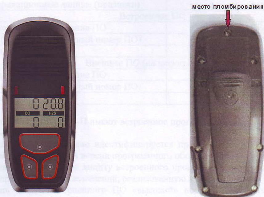
Рисунок 1 - Общий вид и схема пломбирования газоанализаторов СЕАН-П
